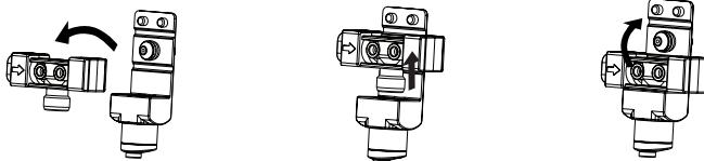
Étape 3 : Repositionnez le système automatique mousseur de lait dans le béc verseur réglable.
